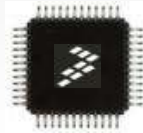
32LQFP 7 x 7 mm 0.8mm pitch (K10/20) (KL0x)
